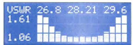
Bild 8: Anzeige des SWV beim Wobbeln um 28 MHz
