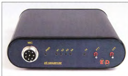
Bild 5: Front des PTT-Sequenzers mit Mikrofonbuchse, Kontroll-LEDs, PTT-Taster und Ausschalter
