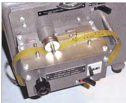
Bild 3: cq de DAN; Morsegeber mit CQ-Schleife
