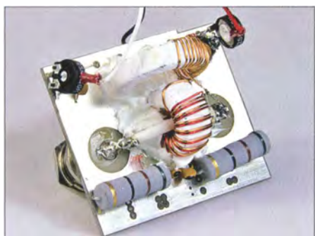
Bild 10: Der KW-Sensor nach Stockton überstreicht einen großen Leistungsbereich.
