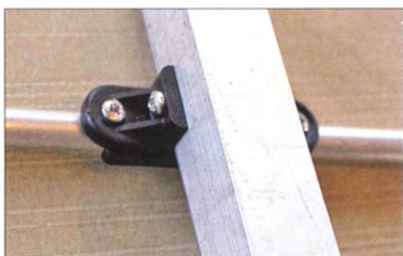
Bild 6: Befestigung des ersten Direktors am Halter zum Verschieben beim Abgleich – hier schon mit seitlicher Fixierung am Boom
