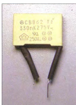
Bild 2: Ein ausreichend spannungsfester Kondensator, der parallel zur LED-Lampe geschaltet wird, beseitigt das Nachglimmen sicher.
