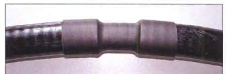
Bild 11: Schrumpfschlauch schützt das sonst freiliegende Dielektrikum.
