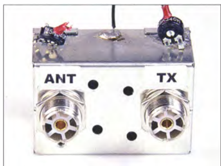
Bild 8: Inklusive Buchsen misst der VHF-Sensor 63 mm × 40 mm × 43 mm (B × H × T).
