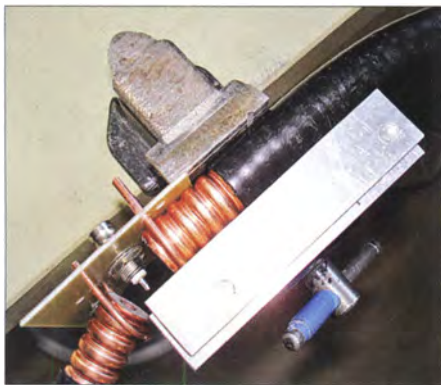
Bild 12: Während des Festlötens der U-Bügel auf der Leiterplatte helfen ein kleiner Schraubstock und ein Metallwinkel, das Koaxialkabel samt Bügel plan auf der Platine zu halten.
