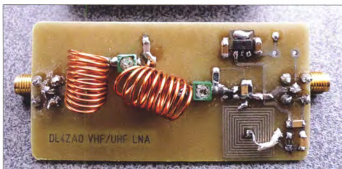
Bild 1: Prototyp des Vorverstärkers auf einer doppelseitig kupferkaschierten Leiterplatte; die SMA-Buchsen sind auf der Unterseite bestückt.
