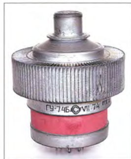
Eine Metall-Keramik-Senderöhre GU-74B (hier aus dem Jahr 1974), wie sie häufig in Amateurfunk-Linearendstufen zu finden ist Foto: DJ1TO
