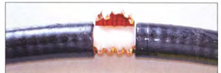
Bild 9: Mit einem Seitenschneider lässt sich der Schirm aufschneiden.
