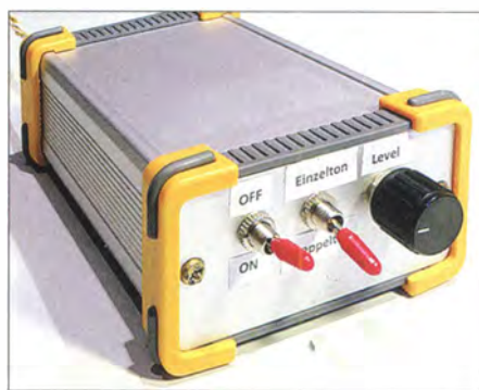
Bild 24: Selbst gebauter NF-Sinus-Zweitongenerator
