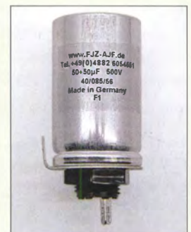
Schraubelektrolytkondensator 50+50 µF/500 V
