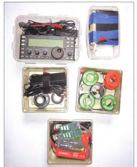
Funkausrüstung in fünf Gefrierdosen; links oben: KX3 mit Kabel für Stromversorgung, Palm-Paddle, Kopfhörer; rechts oben: Akkumulator; Mitte links: Steckernetzteil, Isolierband, Kleinteile; Mitte rechts: Rolle mit Zweidrahtleitung und Koaxialkabel, zwei Antennenhalter, Adapter BNC auf Bananenstecker, Rollen mit Antennendrähten und Abspannleine (Dyneema 1,5 mm)
