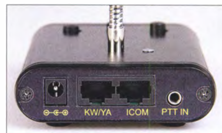
Bild 3: Rückwand des ED2 Deluxe mit Hohlsteckerbuchse 2,1 mm/5,5 mm, Buchsen für Kabel zu Kenwood-/Yaesu- bzw. Icom-Transceivern und ggf. nutzbarem externen PTT-Eingang
