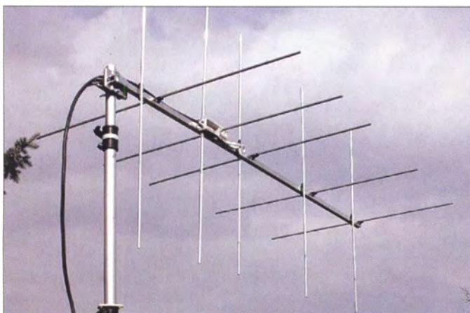
Bild 1: Die 5-Element-Kreuzyagi-Antenne in Vormastmontage
