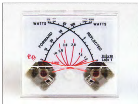
Bild 9: Die Skalen des Kreuzzeigerinstrumentes ED 900 gehen bis 300 W bzw. 60 W (Rücklauf).
