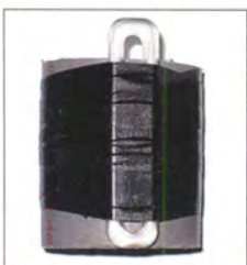
Halter für Vertikalstrahler: HT-Rohr, Mini-Isolator von DX-Wire, Isolierband; so ähnlich ist auch der Halter für die Inverted-V-Antenne aufgebaut.
