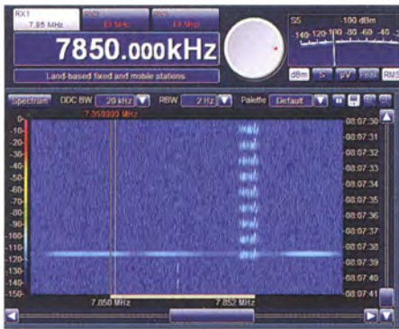
Bild 6: CHU im Sonagramm (Wasserfall) eines PERSEUS SDR: Der Träger ist auf 7850 kHz erkennbar, während die modulierten Zeitsignale auf 7851 kHz und die Datentelegramme ab 7852 kHz folgen. Die Struktur unten links zeigt die Stations- und Zeitsansage kurz vor der vollen Minute. Die senkrechte Linie bei 7850,55 kHz ist eine lokale Störung.
