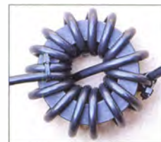
Bild 5: Beispiel für eine wirksame Mantelwellensperre aus RG58 auf einem Ferrit-Ringkern
