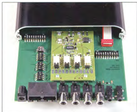
Bild 7: PTT-Sequenzier mit teilweise herausgezogener Platine; r. o. das Mikrofonkabel
