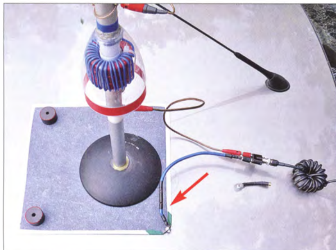
Bild 1: Testaufbau der „Dachkapazität“; gut zu erkennen sind die metallische Kondensatorplatte mit dem Anschlusspunkt (Pfeil) und die Mantelwellensperre auf einem großen Ferrit-Ringkern rechts im Bild.
