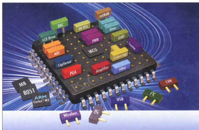
Bild 1: Die in den Mikrocontrollern der PSoC-Technologie enthaltenen Funktionsgruppen lassen sich mit geeigneten Werkzeugen konfigurieren und an nahezu beliebige Anschlüsse des Gehäuses schalten, sodass quasi selbst gebaute Schaltkreise entstehen.
