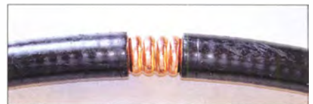
Bild 8: Die 2,5 cm lange Trennstelle mit entferntem Mantel
