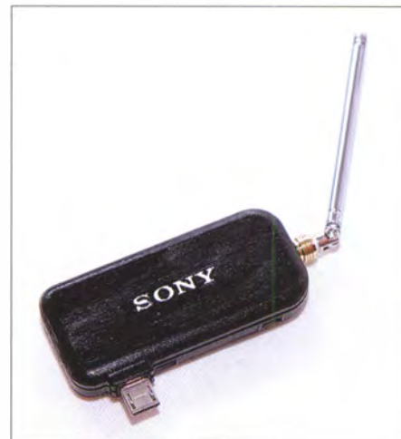
Bild 7: DVB-T2-Stift mit Mini-USB-Stecker, Sony
