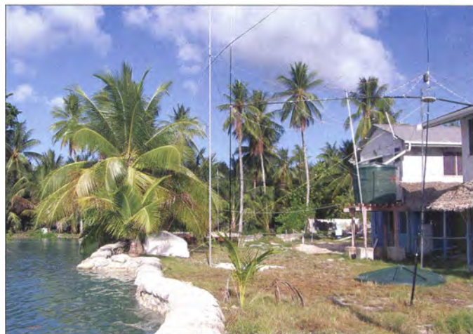
Ein Teil der Antennen zwischen Shack und Lagune; eine Loop für das 30-m-Band, eine Triple-Leg für 17 m, die 4-Element-Yagi für 6 m sowie zwei Speaderbeams
