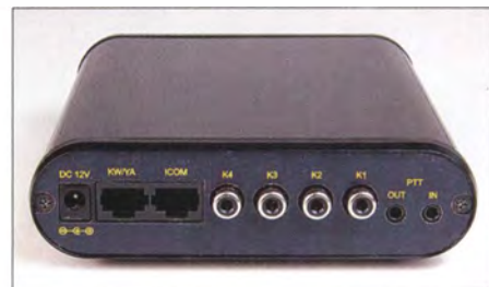
Bild 6: Rückseite des PTT-Sequenzers, u. a. mit Buchsen für das Transceiverkabel und die vier Schaltausgänge Fotos: Autor
