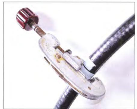
Bild 7: Der Mantel und der darunterliegende Schirm lassen sich mit einem Rohrschneider bearbeiten.
