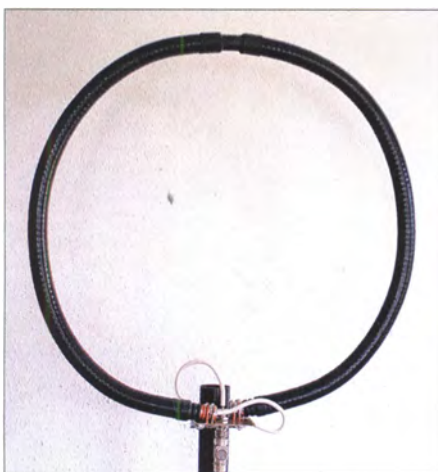
Bild 1: Ansicht der fertigen 10-m-Magnetantenne mit den eingeschobenen Koaxialkabeln.
