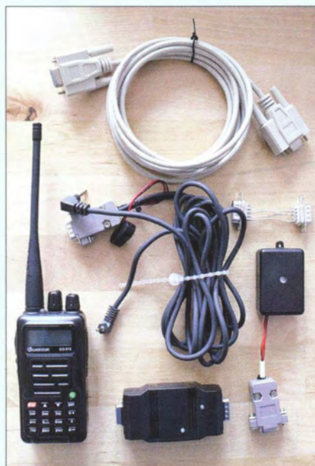
Bild 3: APRS-Komponenten für den preiswerten Einstieg; rechts der GPS-Empfänger, unten in der Mitte der APRS-Tracker Foto: DG5MK
