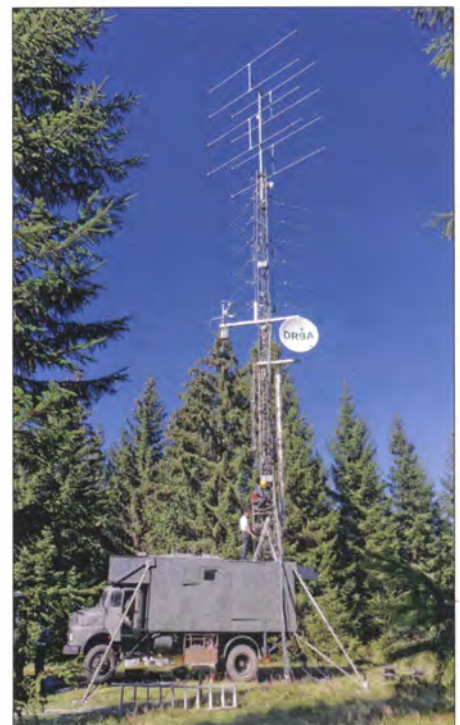
Auf dem Mast ganz oben thront bei DR9A im Schwarzwald (JN48EQ) die 8 x 23-Element-Yagi-Gruppe für 70 cm. Foto: DF9IC
